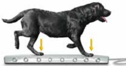
Piattaforma biomeccanica di forza con bilancia integrata. Velocità compresa tra 1,7 e 2,1 m/s
